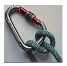
Der Halbmastwurf wird im Bereich der Höhenrettung und Absturzsicherung bei der Feuerwehr zur Sicherung der Einsatzkräfte oder der zu rettenden Person eingesetzt.
